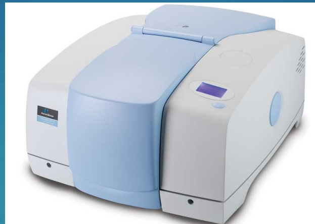
PerkinElmer Spectrum400 Fourier-transzformációs ( FT ) konfiguráció 10000-4000 1/cm
